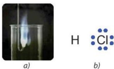
▲ Hình 12.2. Hydrogen phản ứng với chlorine (a) và công thức electron của phân tử hydrogen chloride (b)
