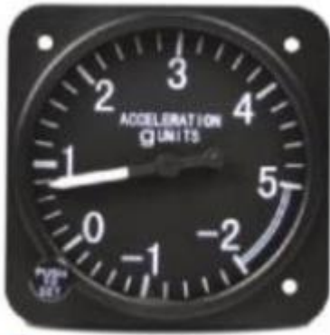
▲ Hình 7.4. Gia tốc kế của máy bay (tính theo gia tốc rơi tự do g )
