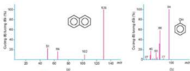
Hình 10.1. Phổ khối lượng của naphthalene (a) và phenol (b)
